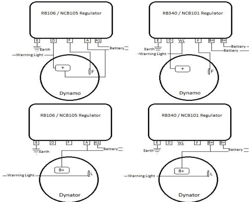
Das NCB133-Modell 340 ersetzt jetzt die alten Regler vom Typ RB310. Es gibt einige physikalische Unterschiede in den beiden Einheiten, aber sie sind austauschbar. Modell 310 wurde mit drei Anschlüssen geliefert; B, F und D. Sein Ersatzmodell RB340 hat fünf; E, D, WL, F und B.
